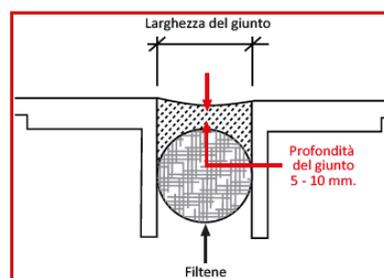
I giunti soggetti a movimento devono avere dimensioni e forma compatibili con le capacità di allungamento del sigillante: sezioni di forma rettangolare con profondità inferiore alla
